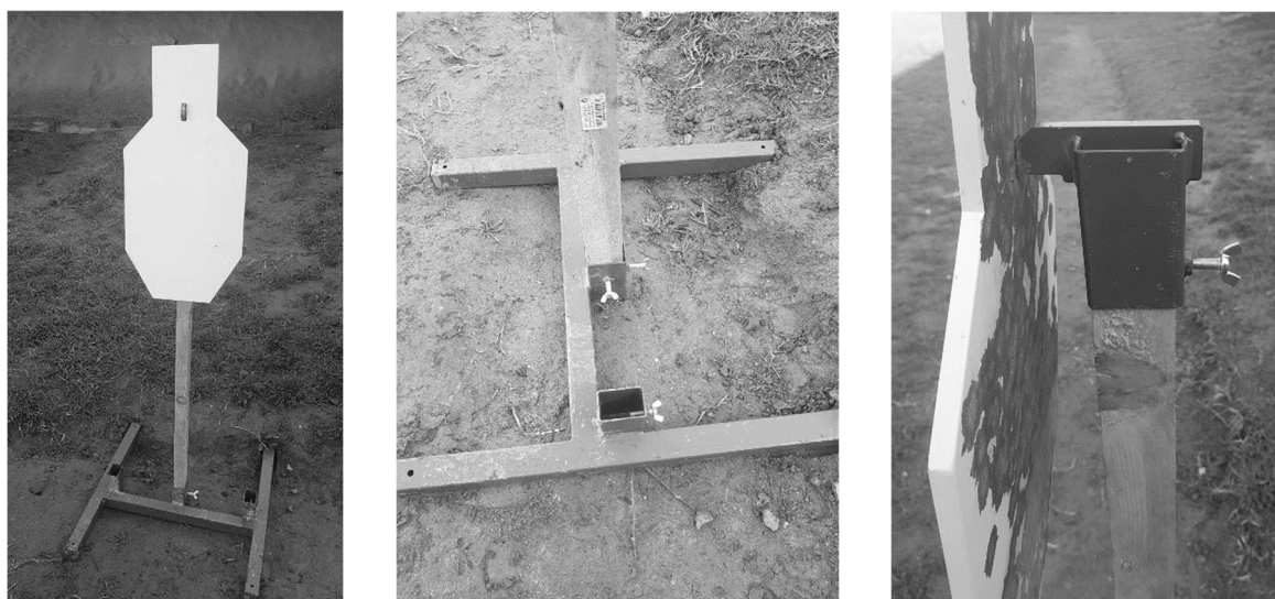
Figura 3-2 – Alvos metálicos com base em metal, coluna em madeira e suporte
