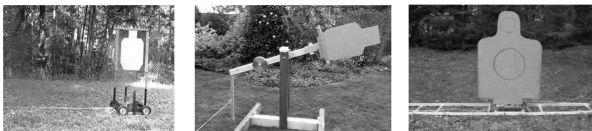
Figura 5-1 – Alvos móveis improvisados com rolamentos, contrapeso e em calha
